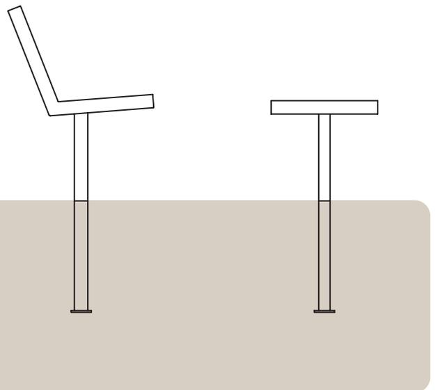
**Vorteil:** Durch das Einbetonieren der Gestelle entfallen zusätzliche Kosten für Bodenanker.
