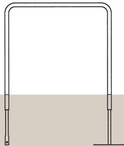
Tisch T-RE 12070/2 und T-RE 18070/2 mit Rohrgestell 2 und Bodenanker M-BA 2 oder M-BA 3
