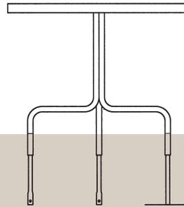
Tisch T-RU 10072/2 mit Rohrgestell 2 und Bodenanker M-BA 2 oder M-BA 3
